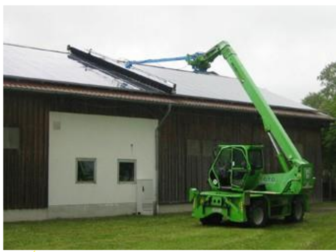
A teleszkópos rakodótól függően magasabb tetők is gond nélkül megtisztíthatók.
